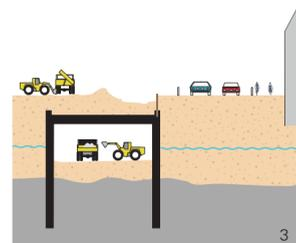
Der Deckel wird überschüttet und die Baugrube wieder verfüllt. Nach dem vollständigen Abpumpen des Grundwassers erfolgt unter dem Deckel der Aushub bis zur Sohle.
