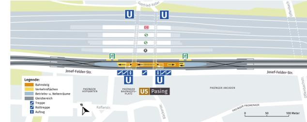
Die Auf-/Zugänge von der U-Bahn münden in den bestehenden Hauptzugangstunnel der Deutschen Bahn und in den Tunnel für den Fuß- und Radverkehr am östlichen Ende des Pasinger Bahnhofs.
